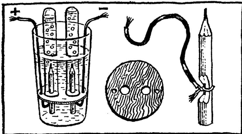
электродами. На неочиненных концах карандашей сделайте зарубки, чтобы обнажились грифели, и примотайте к ним оголенные концы проводков. Проводки скрутите и тщательно обмотайте изоляционной лентой, а чтобы изоляция была совсем надежной, лучше всего спрятать проводки в резиновых трубках. Все детали прибора готовы, остается только собрать его, т. е. вставить кружок с электродами внутрь стакана.
