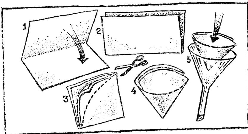
Чтобы сделать фильтр, надо приготовить квадратный кусок фильтровальной бумаги, сложить его пополам и еще раз пополам, а потом обрезать края так, чтобы при разворачивании получился круг. Такой сложенный вчетверо листок надо раздвинуть, чтобы образовался конус. Половина этого конуса будет из одного слоя бумаги, другая половина — из трех слоев.
