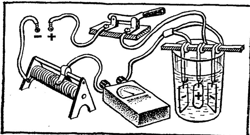
рубильник и реостат, чтобы регулировать ток. Для его измерения нужен миллиамперметр, но годится и тестер, который есть у многих радиолюбителей. Замкните цепь и установите ток из расчета 20-25 мА на 1 см<sup>2</sup> поверхности. Деталь сразу покроется пузырьками газа — это выделяется кислород, который и окисляет алюминий. При комнатной температуре процесс длится около часа.
