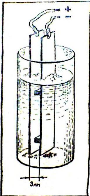
высокую мензурку или большую бирку. Перед опытом просверлите в пластинах с одной стороны отверстия для прикрепления проводников. Приготовьте две одинаковые, толщиной буквально в несколько миллиметров, пластмассовые или деревянные прокладки и склейте их с металлическими полосками так, чтобы те, расположившись параллельно, не касались друг друга. Клей годится практически любой — БФ, «Момент» и др.
