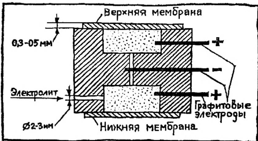
Прибор уже почти готов. Осталось лишь приклеить к нему сверху и снизу по тонкой мембране из того же оргстекла, только небольшой толщины (0,3—0,5 мм). Пока приклейте только нижнюю мембрану.
