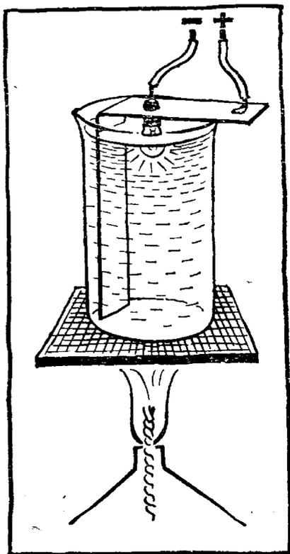
небольшой химический стакан так, чтобы стеклянный баллон лампочки оказался внутри стакана и был обращен к его дну. Подключите лампочку к батарейке; выступ на цоколе, самый крайний его участок соедините с отрицательным полюсом, а полоску жести — с положительным. Обратите внимание: припаивать проводники нельзя, потому что во время опыта припой может расплавиться. Надо придумать механический контакт или же использовать патрон от старого карманного фонаря.
