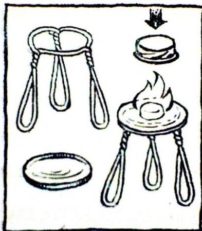
Еще один способ нагревания до высокой температуры — песочная баня. В небольшую сковородку насыпьте ровным слоем сухой прокаленный песок на высоту около 2 см. На песок поставьте фарфоровую чашку или металлическую банку с реакционной смесью и нагревайте песочную баню на электроплитке. Это старый, надежный и безопасный метод прокаливания, хотя и не очень быстрый.
